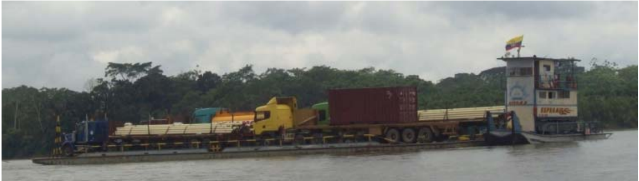
Figura 5–1. Ejemplo de remolcadores y barcazas “tipo ecuatoriano” varadas sobre bancos de arena (Aptos, por su escaso calado, para navegar en el río Napo)
