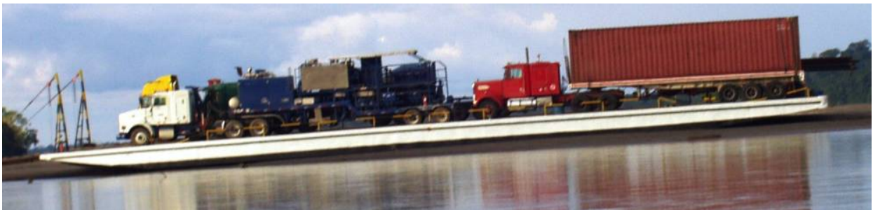
Figura 5–2. Ejemplo de un remolcador y barcaza “tipo brasileño” (Aptos, por su mayor calado, para navegar en el río Amazonas)
