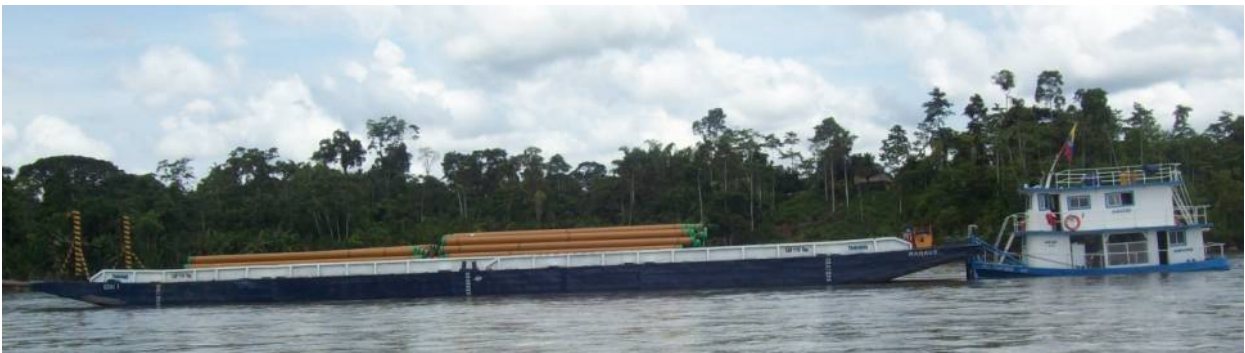
Figura 5–2. Ejemplo de un remolcador y barcaza “tipo brasileño” (Aptos, por su mayor calado, para navegar en el río Amazonas)
